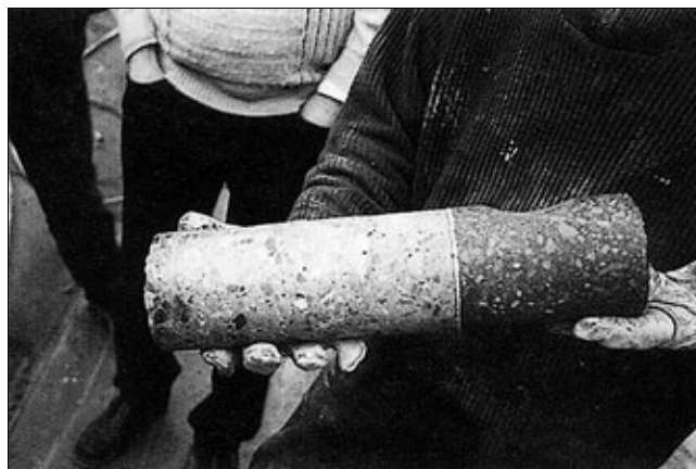
Рис. 4. Керн, взятый из опытной системы бетонная панель — асфальтобетон (правая часть — слой асфальтобетона, уплотненного гидроструктурированной смолой)
