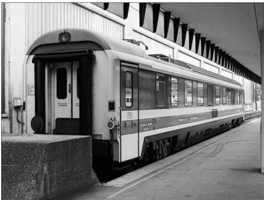
Рис. 1. Путеизмерительный вагон EM 250
