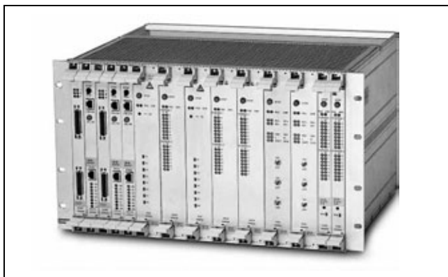
Рис. 1. Базовый каркас удвоенной высоты
