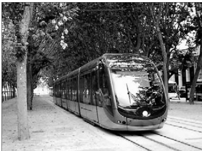
Рис. 13. Вагон серии Citadis 302 на участке линии трамвая без контактной сети
