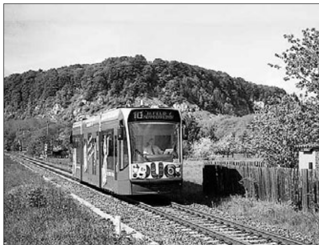
Рис. 14. Вагон Combino Duo компании Siemens с комбинированным тяговым приводом на неэлектрифицированной линии
