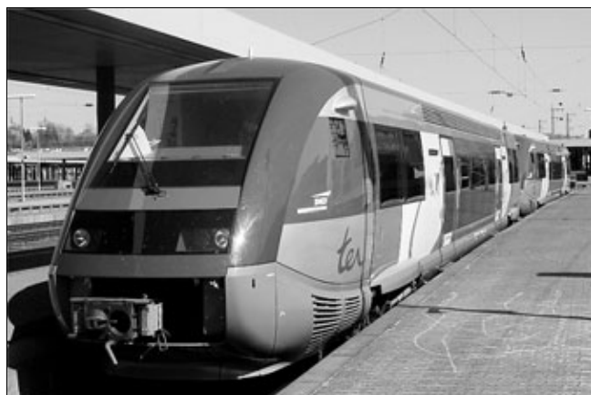
Рис. 3. Поезд серии X73900 SNCF, оснащенный системой для обращения в сетях Франции и Германии
