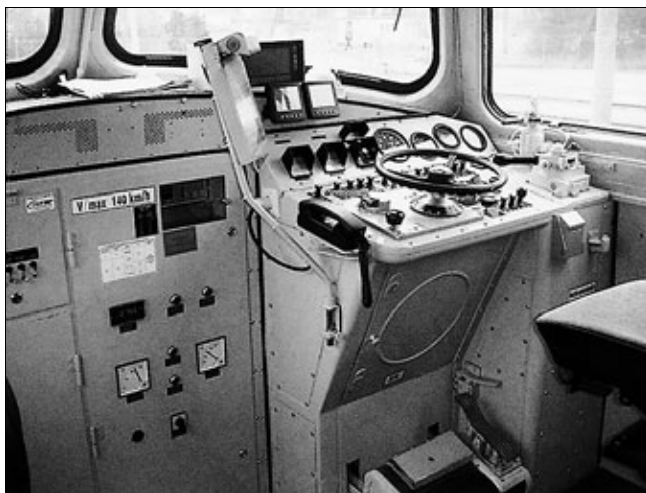
Рис. 3. Пульт управления модернизированного тепловоза
