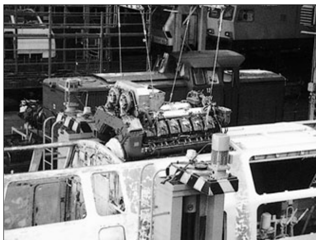
Рис. 2. Установка нового дизеля на заводе компании ОМВ в Нойштрелице
