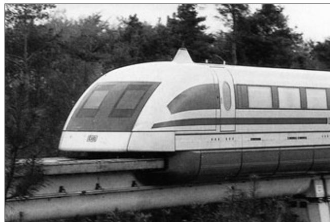
Рис. 6. Концевая секция поезда Transrapid с антенной на крыше
