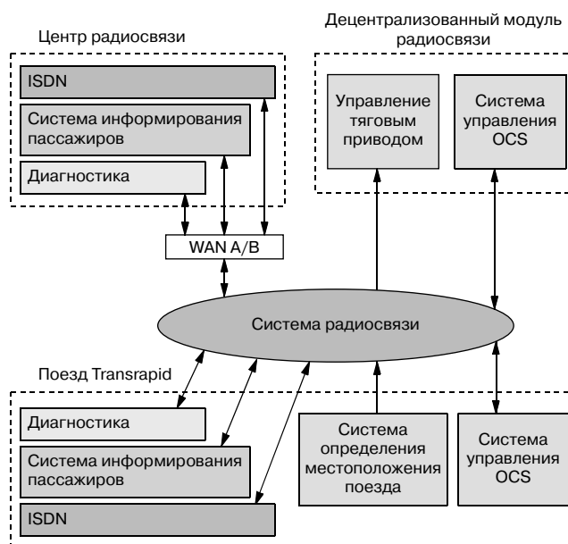
Рис. 2. Интеграция системы радиосвязи в систему OCS: ISDN — интегрированная цифровая сеть связи; другие обозначения — см. рис. 1
