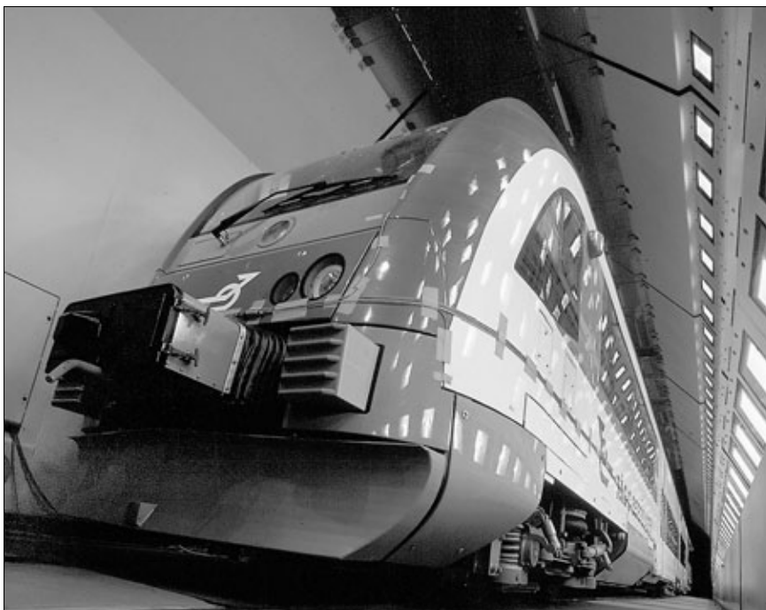
Рис. 3. Испытания регионального поезда с имитацией солнечного облучения
