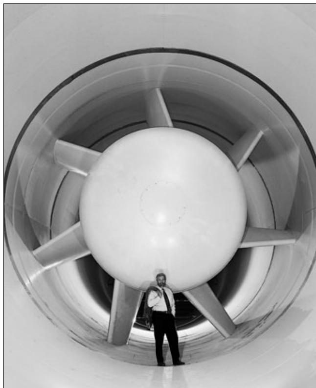
Рис. 2. Вентилятор большой аэродинамической трубы мощностью 4,75 МВт с диаметром лопастей 6,3 м
