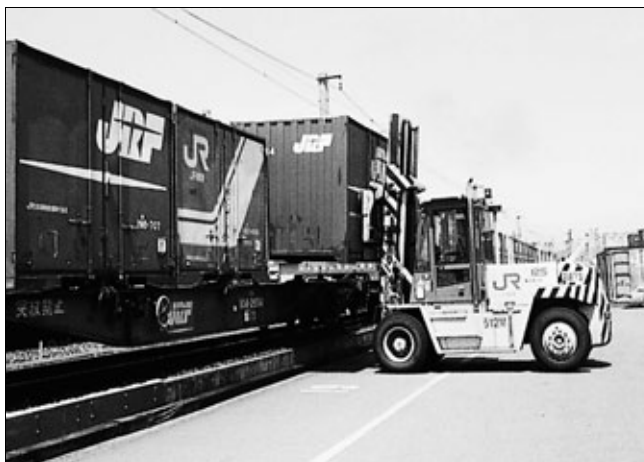
Рис. 3. Погрузка/разгрузка контейнеров без расцепки поезда
