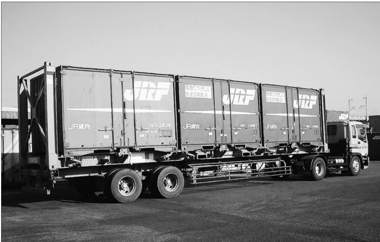
Рис. 2. Три контейнера длиной 3,6 м на стандартном рамном поддоне длиной 12 м
