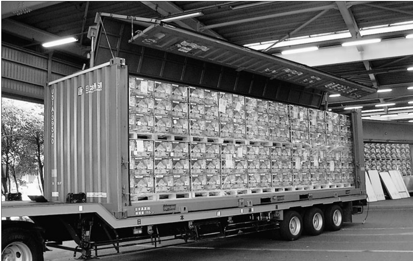
Рис. 1. Контейнер длиной 9,3 м с откидывающимися боковыми стенками
