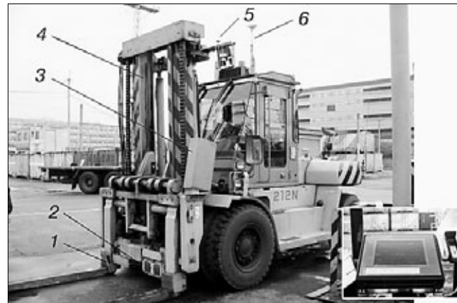
Рис. 5. Вилочный погрузчик, оснащенный оборудованием системы TRACE, и интерактивный дисплей в кабине управления:
