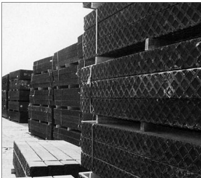
Композитные пластиковые шпалы с шероховатой боковой поверхностью
