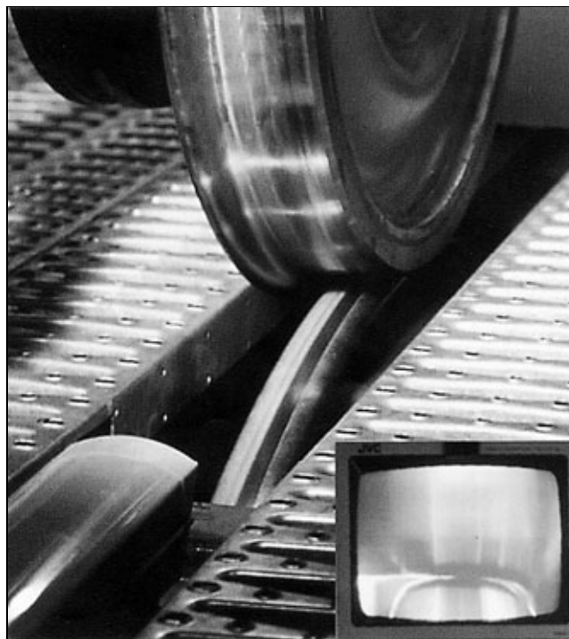
Рис. 3. Изображение зоны контакта колесо — рельс, выведенное на монитор
