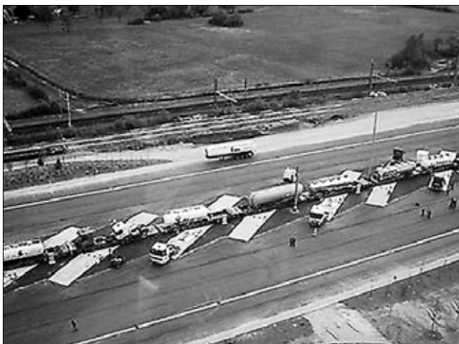
Рис. 6. Погрузка автоприцепов на платформы по технологии Modalohr
