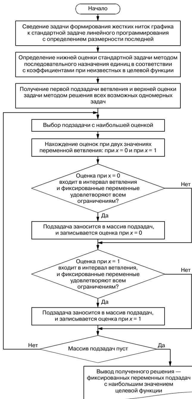
Рис. 2. Алгоритм формирования твердых ниток
