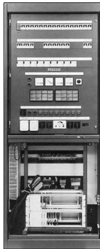
Рис. 8. Распределительный шкаф пассажирского вагона ÖBB
