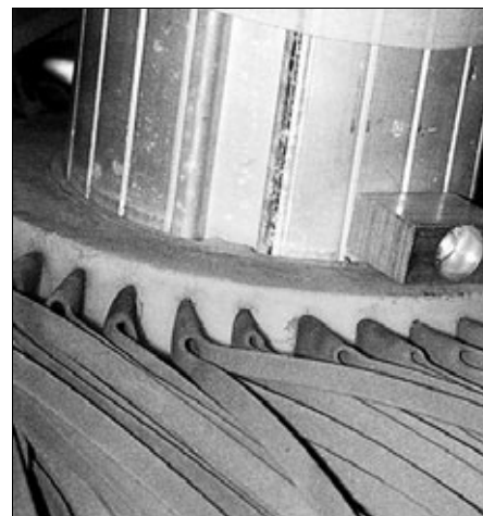
Рис. 4. Фрагмент щетки из губчатого материала Carlite
