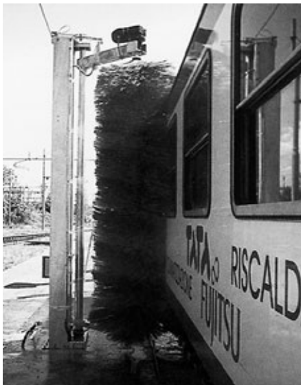
Рис. 1. Боковая вертикальная щетка на подпружиненном кронштейне
