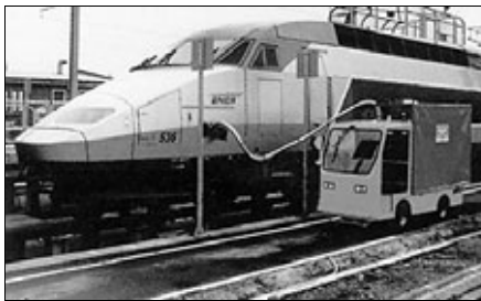
Рис. 5. Мобильная установка для снабжения песком электропоездов TGV в депо Ланди (Франция)
