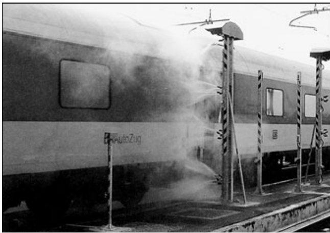
Рис. 2. Стойка с форсунками для распыления воды под высоким давлением
