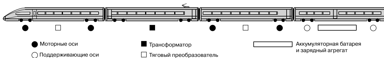
Рис. 2. Конфигурация поезда Velaro E (половина состава)
