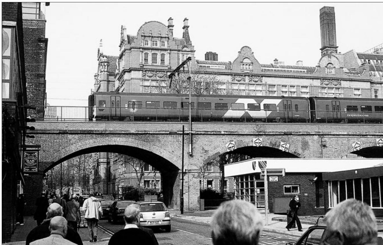
Рис. 2. Дизель-поезд серии 158 на кирпичном арочном мосту между станциями Пикадилли и Оксфорд-Роуд. Два пути оборудованы сигнализацией для движения в обоих направлениях
