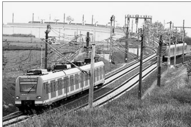
Рис. 6. Обкатка линии под напряжением в контактной сети в месте примыкания к высокоскоростной магистрали Кёльн — Франкфурт-на-Майне в Порц-Ванне
