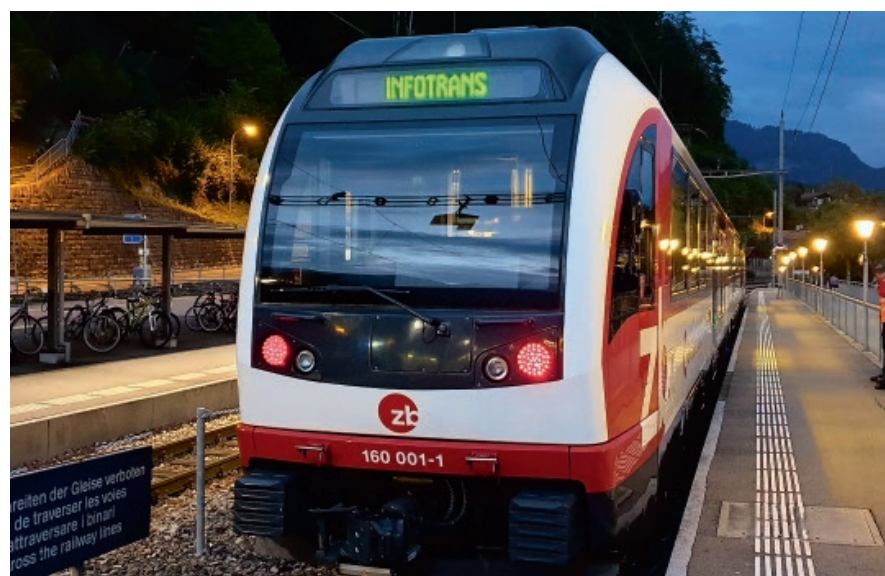
Рис. 1. Пассажирский электропоезд FINK, оборудованный бортовой системой диагностики пути ATM
