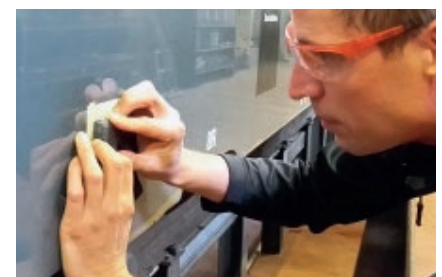
Монтаж транспондера RFID на боковую поверхность кузова вагона
