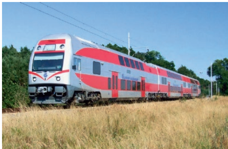
Рис. 8. Двухэтажный электропоезд серии 575 колеи 1520 мм, построенный Škoda для железных дорог Литвы (фото: Škoda)
