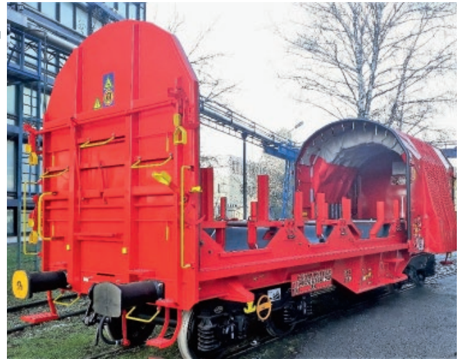
Рис. 10. Вагон постройки компании Đuro Đaković для перевозки стали в рулонах
