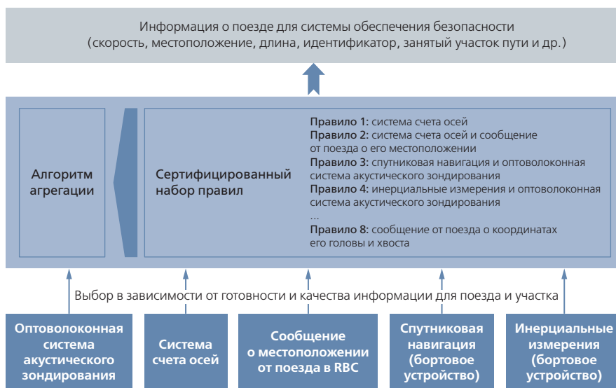
Рис. 3. Гибкое использование датчиков разных видов в ETCS-МПЦ
