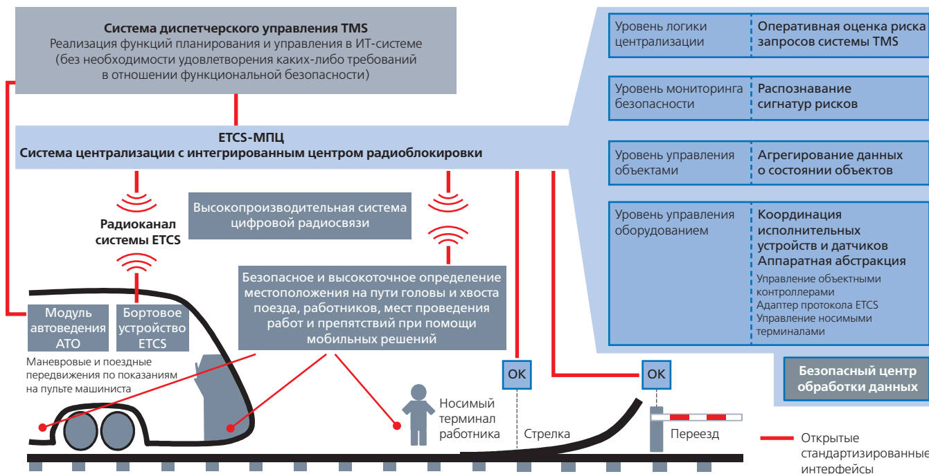
Рис. 1. Архитектура комплекса средств управления и обеспечения безопасности движения поездов. Логика централизации ориентирована на бессветофорную систему ETCS
