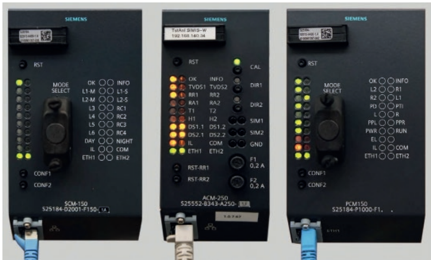
Рис. 6. Объектные контроллеры компании Siemens для цифровой МПЦ. Слева — светофорный контроллер SCM, в центре — контроллер системы счета осей, справа — стрелочный контроллер
