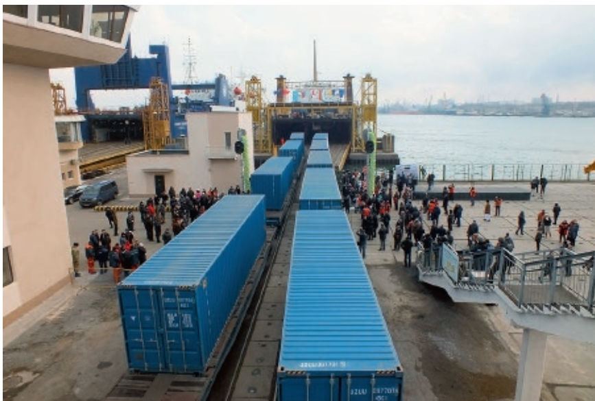
Рис. 2. Погрузка вагонов с контейнерами на паром в порту Черноморск
