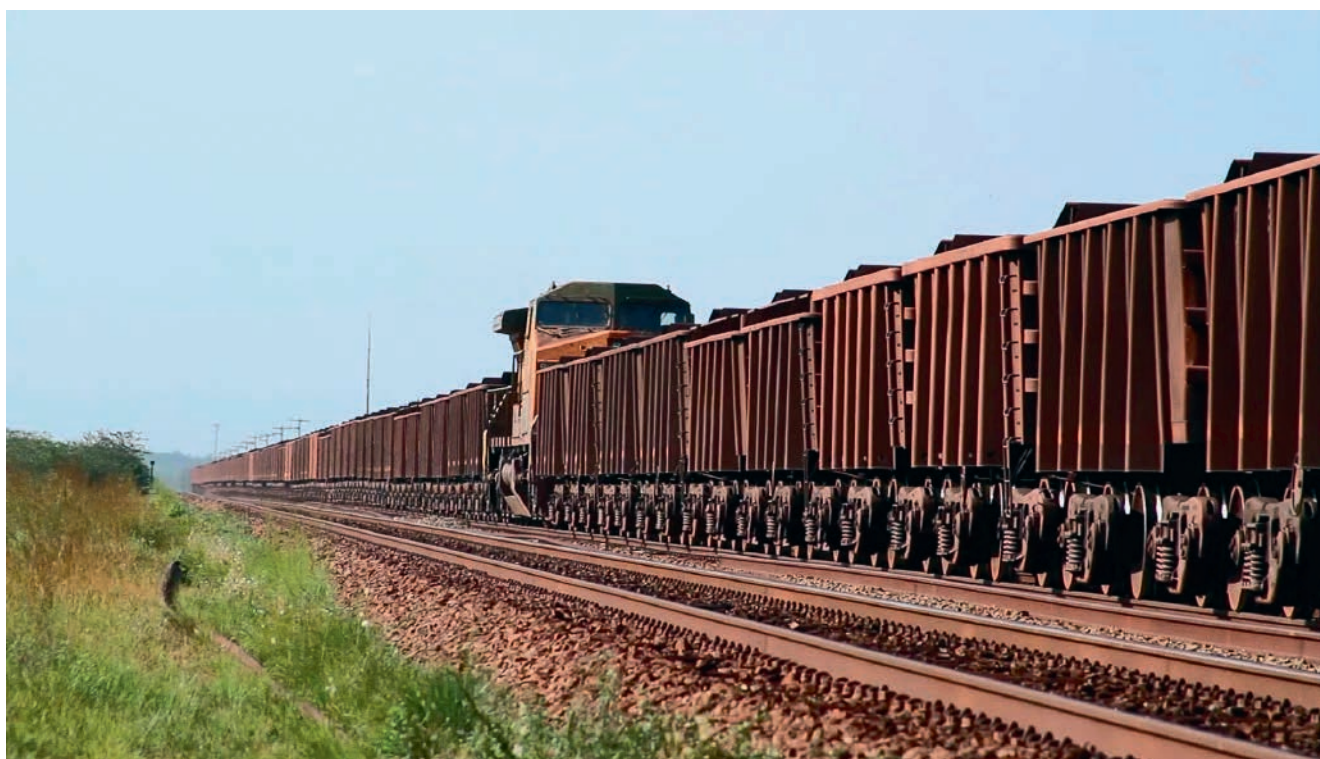
Рис. 1. Поезд из 330 вагонов с железной рудой на пути в порт Сан-Луис
