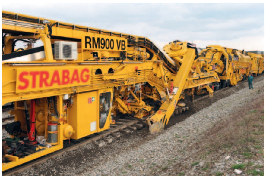
Рис. 1. Балластоочистительная машина RM 900 VB (фото: Plasser & Theurer)
