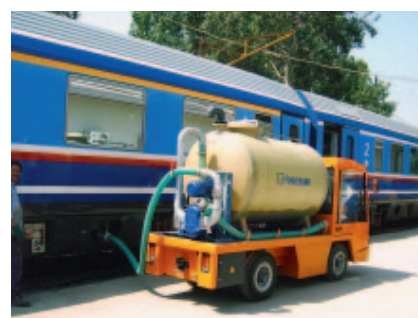
Рис. 7. Передвижное устройство для очистки вагонных биотуалетов (фото: Vogelsang)
