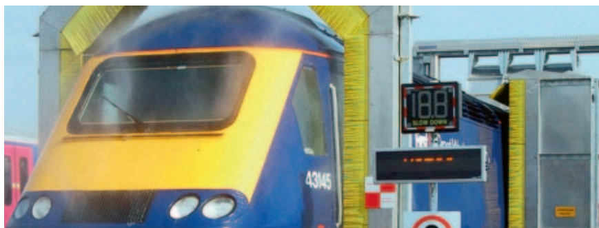
Рис. 2. Стационарная установка для обмывки подвижного состава (фото: Garrandale)
