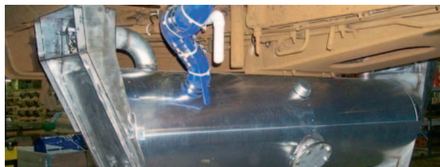
Рис. 4. Накопительный резервуар биотуалета (фото: Garrandale)
