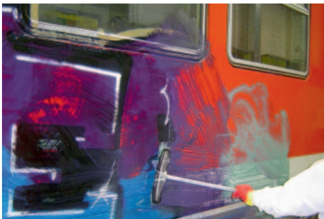
Рис. 5. Удаление граффити с помощью средства P3 Scribex 400 (фото: Henkel)
