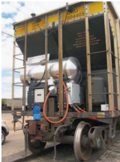
Рис. 1. Установленное на грузовом вагоне устройство для подачи модификатора трения KELSAN AutoPilot
