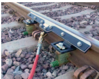
Рис. 3. Устройство для подачи модификатора трения на рабочую поверхность головки рельса
