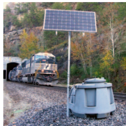
Рис. 4. Устройство для лубрикации рельсов, установленное компанией Lincoln Industrial на одной из линий железной дороги Norfolk Southern в штате Теннесси
