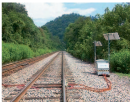
Рис. 2. Устройство для смазывания рабочих поверхностей рельсов обоих путей одного из участков железной дороги первого класса, разработанное компанией L. V. Foster
