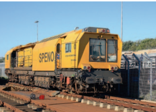
Рис. 2. Поезд RR 16 MS для шлифования рельсов на стрелочных переводах
