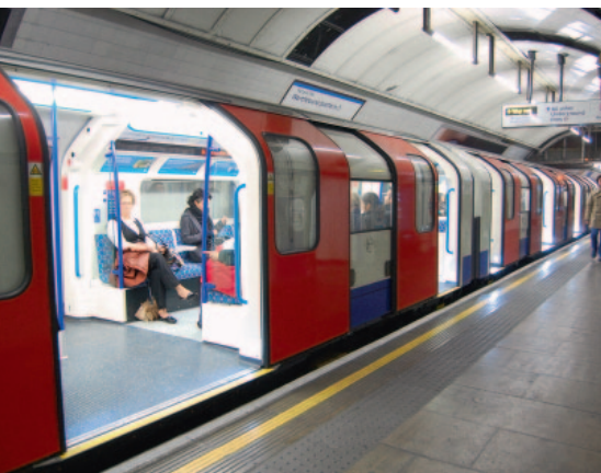
Рис. 3. Поезд линии Victoria метрополитена Лондона со сдвижными дверями
