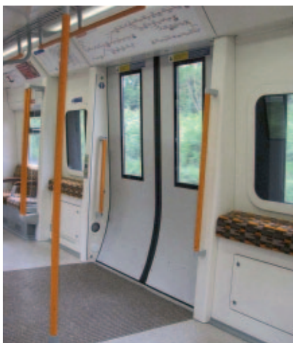
Рис. 4. Интерьер вагона электропоезда серии 378 с раздвижными дверями, створки которых убираются в полости кузова
