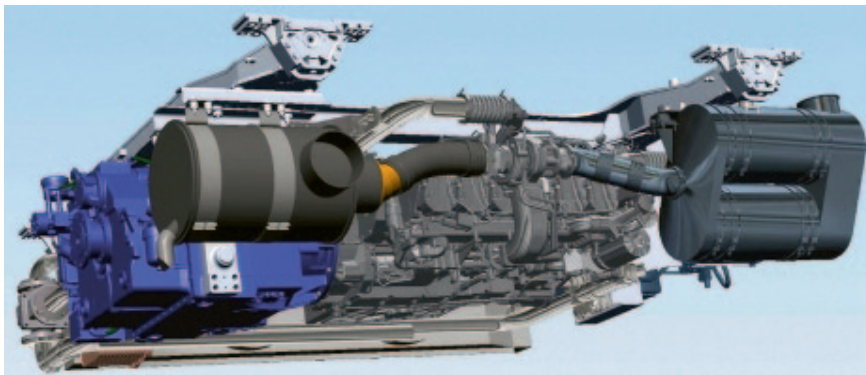
Рис. 2. Силовой агрегат для железнодорожного подвижного состава с применением технологии SteamTrac (источник: Voith Turbo)
