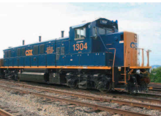
Рис. 8. Тепловоз серии 3GS21B железной дороги CSXT, оснащенный тремя силовыми агрегатами (построен компанией National Railway Equipment)
