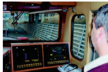
Рис. 5. Дисплей системы Trip Optimizer в кабине управления тепловоза
