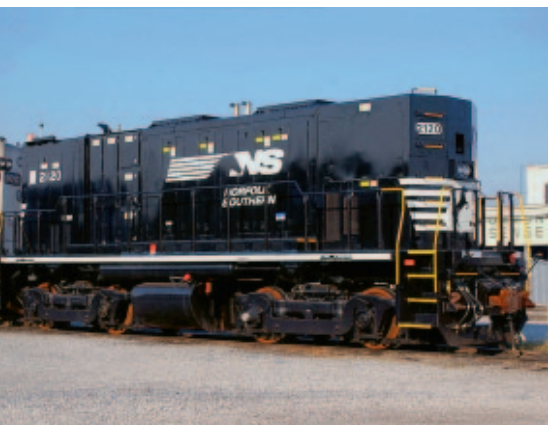
Рис. 3. Тепловоз серии RP20BD железной дороги NS, оснащенный двумя силовыми агрегатами (построен компанией RJ Cogman Railpower)
