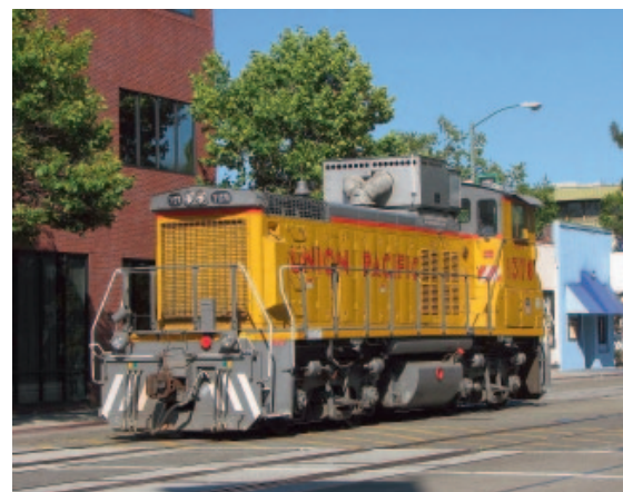
Рис. 6. Маневровый тепловоз железной дороги Union Pacific с дополнительным фильтром для улавливания несгоревших твердых частиц в выхлопных газах
