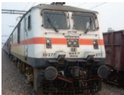
Рис. 3. Электровоз WAP7 № 30277, переоборудованный для питания пассажирского поезда
