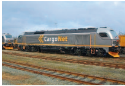
Рис. 2. Тепловоз Euro 4000 для эксплуатации в условиях Северной Европы
