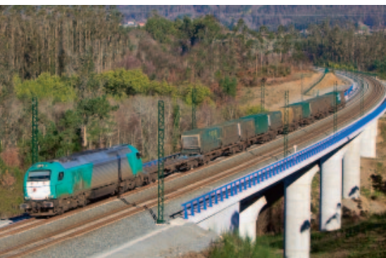
Рис. 1. Универсальный шестиосный тепловоз с электрической передачей Euro 4000
