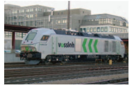
Рис. 3. Тепловоз Eurolight для международных сообщений на второстепенных линиях
