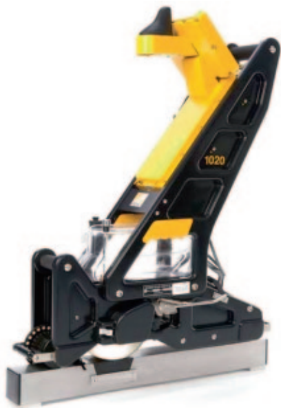
Рис. 1. Ручной дефектоскоп типа BSSRWS компании Sperry (источник: Sperry)
