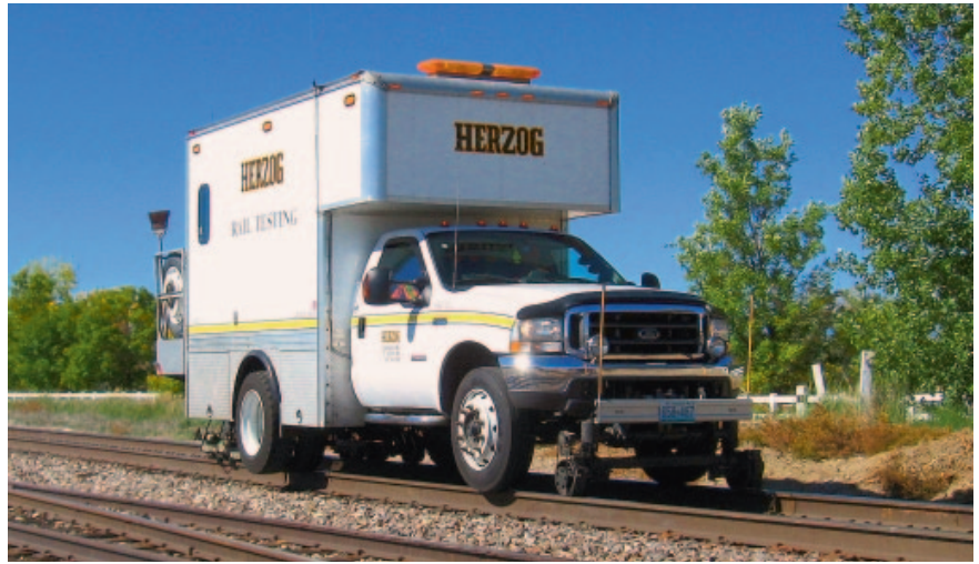
Рис. 3. Машина-дефектоскоп компании Herzog Railroad Services на комбинированном ходу
