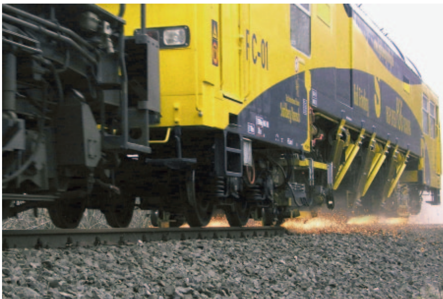
Рис. 3. Поезд с рельсошлифовальным вагоном RC01
