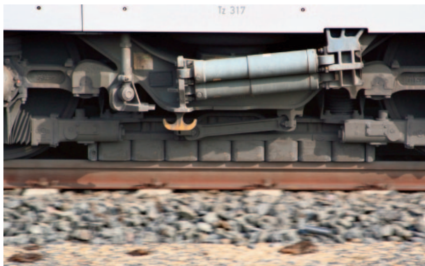
Рис. 1. Линейный вихретоковый тормоз поезда ICE 3
