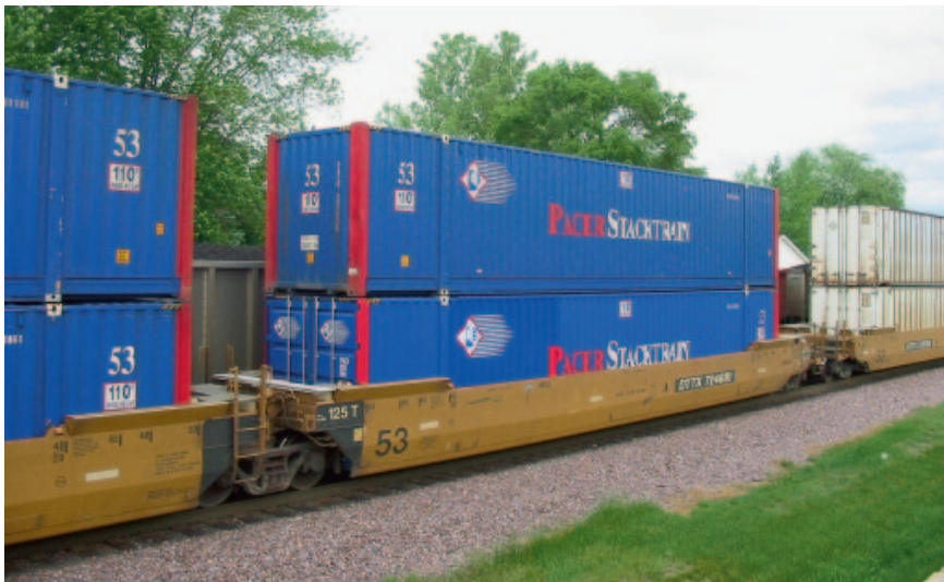
Рис. 4. Сочлененная платформа колодезного типа для двухъярусной погрузки контейнеров
