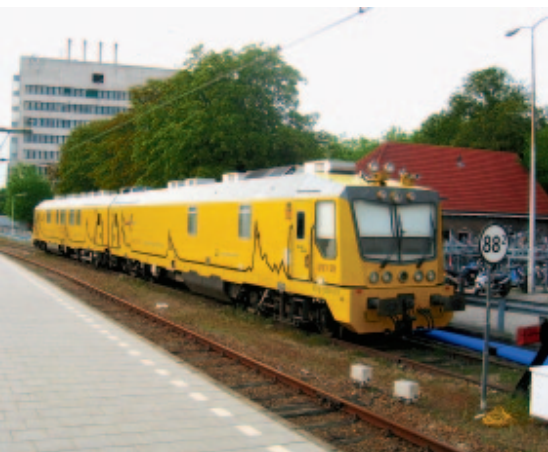
Рис. 5. Путьинспекционный поезд UST 02
