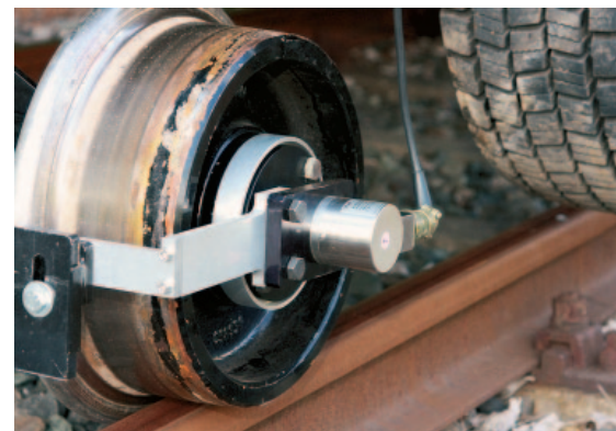
Рис. 3. Импульсный колесный датчик пройденного пути и скорости
