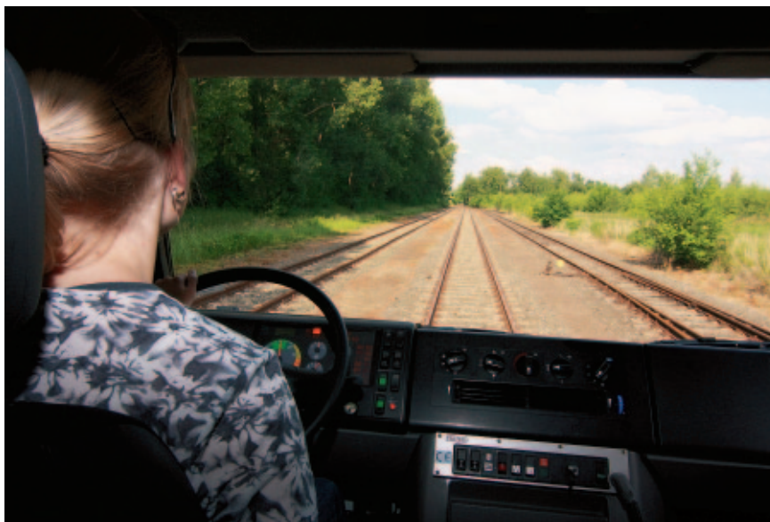
Рис. 2. В кабине RailDriVE при движении на рельсовом ходу
