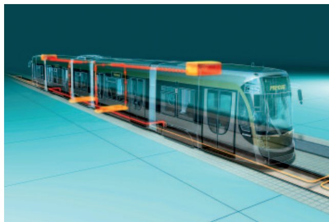
Принцип бесконтактной передачи энергии
