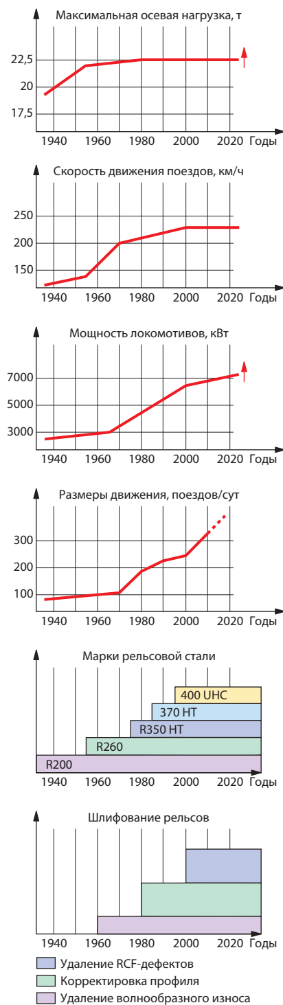
Рис. 1. Развитие технологий шлифования рельсов по мере усложнения условий эксплуатации
