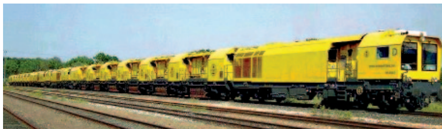
Рис. 4. Две рельсошлифовальные машины компании Speno с 48 камнями каждая, соединенные для выполнения шлифования за один проход
