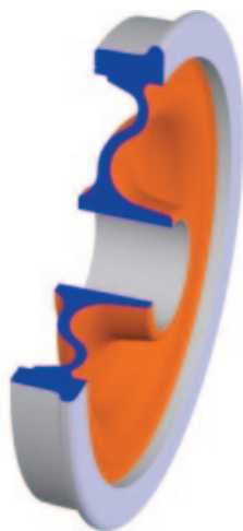
Рис. 5. Оптимизированное колесо компании Bonatrans для грузовых вагонов
