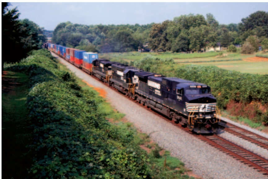
Рис. 2. Грузовой поезд железной дороги Norfolk Southern с контейнерами в два яруса (фото: NS)
