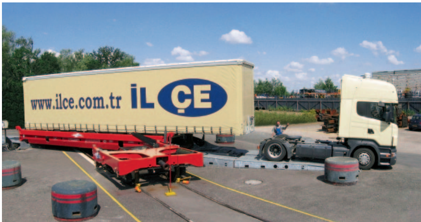
Рис. 4. Накатка автомобильного полуприцепа на платформу по технологии Modaloehr
