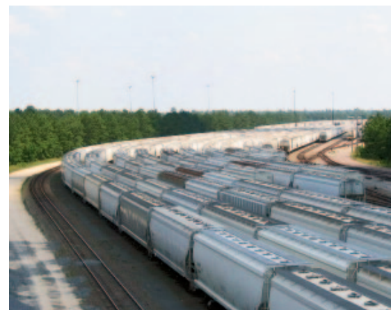
Рис. 5. Вагоны как мобильные склады для гранулированных пластмасс
