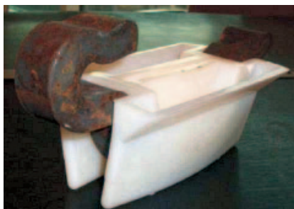
Рис. 1. Рельсовый противоугонон для пути на железобетонных шпалах
