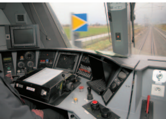
Рис. 1. В кабине машиниста поезда, оборудованного системой ETCS уровня 1. Машинист снизил скорость, готовясь к отклонению на боковой путь
