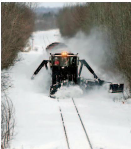
Рис. 2. Снегоочиститель типа Plow Extra с распределителем типа Jordan на линии железной дороги CP в районе г. Сент-Эдуард, провинция Квебек (Канада)
