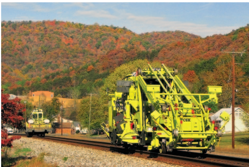
Рис. 3. Шпалоподбивочная машина типа Jackson 6700 Tamper железной дороги CSXT направляется на фронт работ в районе г. Толкотт, штат Западная Виргиния (США)
