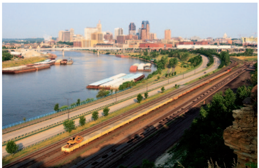
Рис. 1. Балластный поезд типа Slot Machine перед выходом на работы по проекту Northstar Commuter Rail, реализуемому железной дорогой BNSF в районе г. Сент-Пол, штат Миннесота (США)
