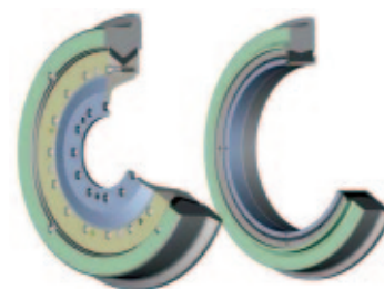
Рис. 4. Современные конструкции колес с резиновыми амортизаторами, обеспечивающие простую и быструю замену бандажа
