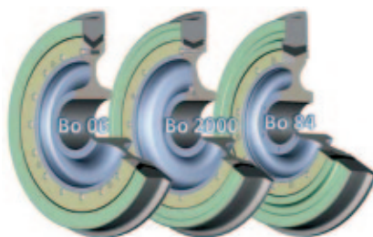
Рис. 5. Различные варианты исполнения колеса с одним амортизирующим элементом и съемным кольцом колесного центра
